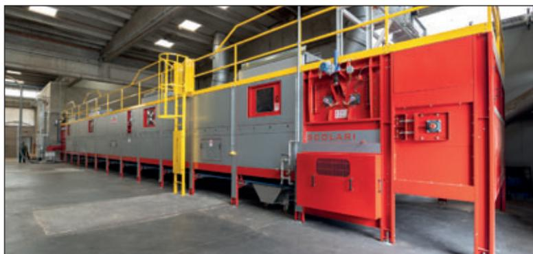
quella con tappeti mobili forati, processo a bassa temperatura, struttura e componenti a contatto del prodotto in essiccazione realizzati pressoché Aisi, isolamento termico del corpo macchina.
