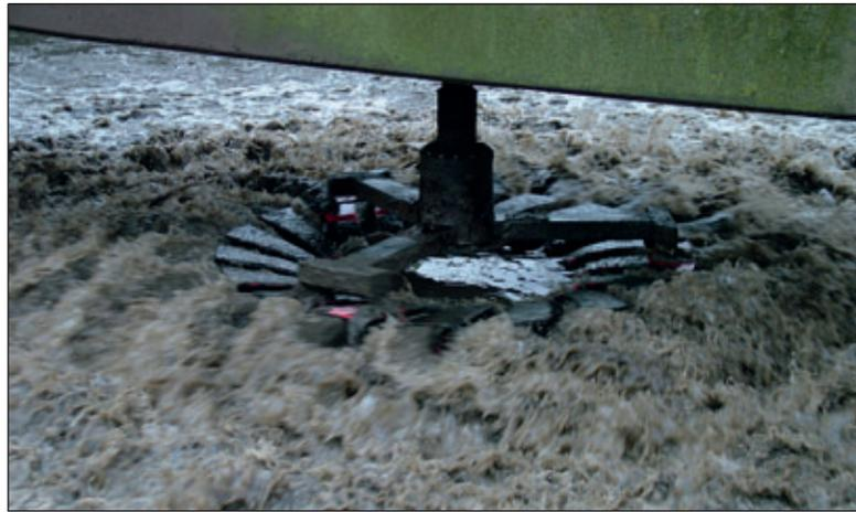
que reflue per usi industriali. Ulteriori vantaggi sono una significativa riduzione degli odori, dei composti organici volatili (COV) e della formazione di schiuma, una capacità di risposta rapida alle variazioni del carico organico, e la massima efficienza di trasferimento di ossigeno nell'acqua (fino al 95%), a fronte di costi di investimento minimi.
